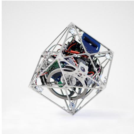
Bild 4-2: Der Cubli verfügt über drei Schwungräder, mit denen er durch geschicktes Beschleunigen und Abbremsen aus der stabilen Ruhelage in einem ersten Schritt auf eine seiner Kanten springen und schlussendlich auf einer Ecke stabilisiert werden kann. [21]
